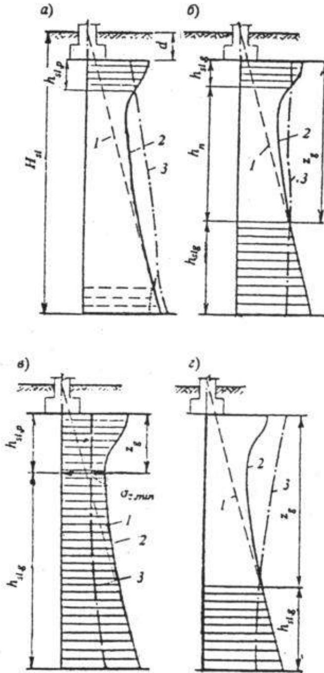
Рис. 4. Схемы к расчету просадок основания
